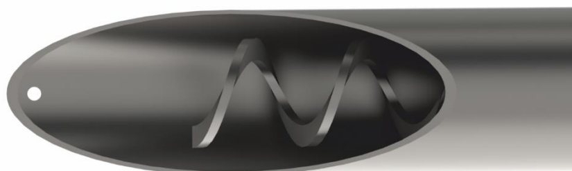
Fig. 6. Assemblage de la vis d'alimentation du réservoir.
